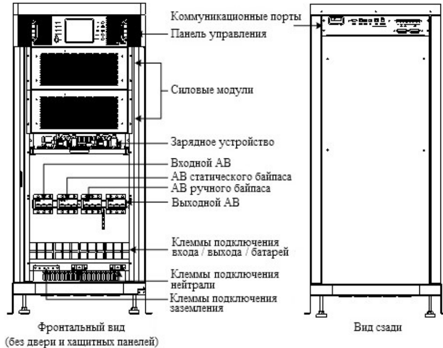
Рисунок 1.2 Структура ИБП мощностью 40 кВА – 60 кВА
